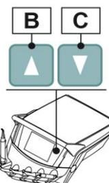
Устройство остановки пружинных рычажков возврата инструментов (только вариант исполнения со шнурами с верхней подачей).
